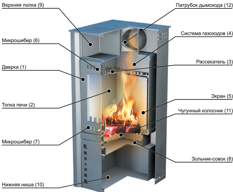
**Рисунок – 1.** Устройство печи-камина отопительного
