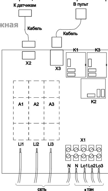
Рис. 2. Схема электромонтажная
