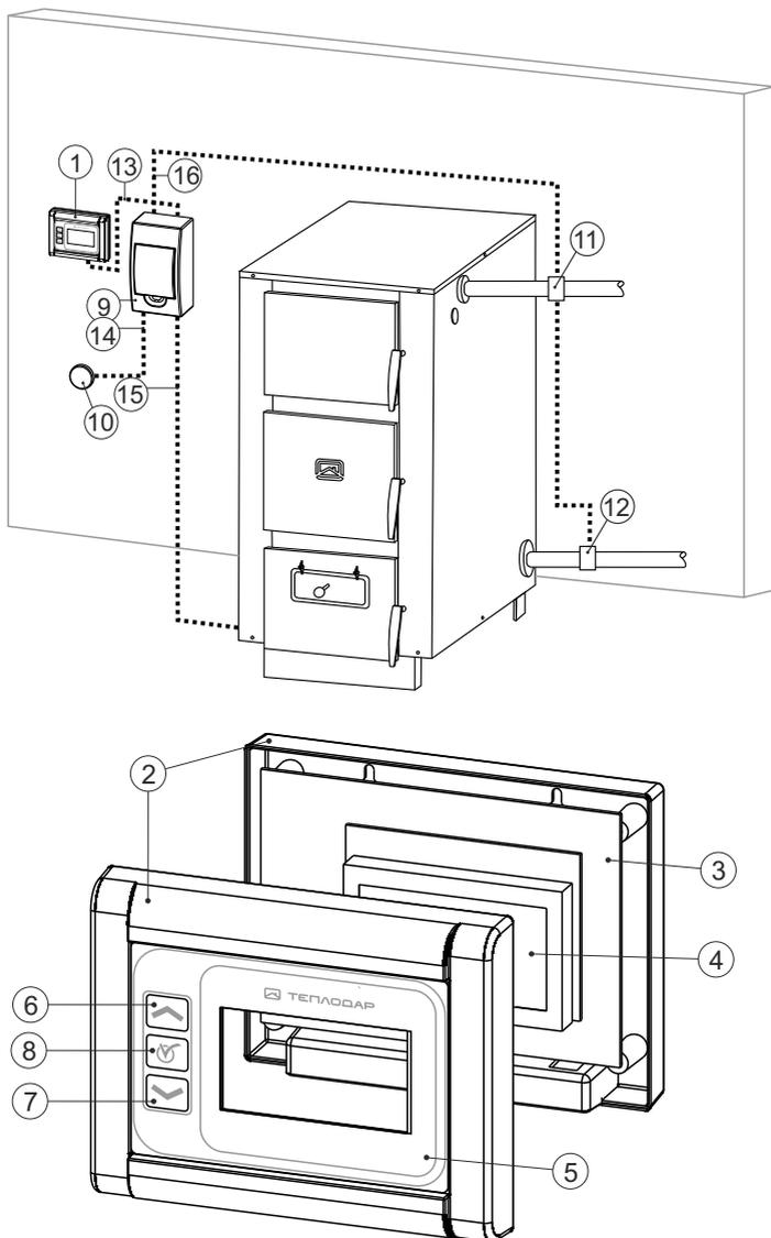
1 — Блок управления (БУ); 2 — Корпус БУ; 3 — Плата управления; 4 — ЖК индикатор; 5 — Пленочная клавиатура; 6,7 — кнопки управления; 8 — Кнопка «Ввод»; 9 — Блок коммутации (БК); 10 — вилка питания; 11 — датчик температуры (ДТ) подачи; 12 — Датчик температуры (ДТ) «обратки»; 13 — шлейф управления БК; 14 — кабель питания; 15 — Кабель питания блока ТЭН; 16 — провод ДТ.
