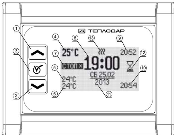
1,2 — клавиши «Вверх», «Вниз»; 3 — Клавиша «Ввод»; 4 — индикатор температуры в помещении; 5 — индикатор температуры «обратки»; 6 — Индикатор температуры «подачи»; 7 — индикатор переключения режимов «меню/пуск/стоп»; 8 — установленное время; 9 — время запрограммированного выключения; 10 — Время запрограммированного выключения; 11 — установленная дата; 12 — индикатор режимов «работа/ожидание»; 13 — индикатор режима нагрева.
