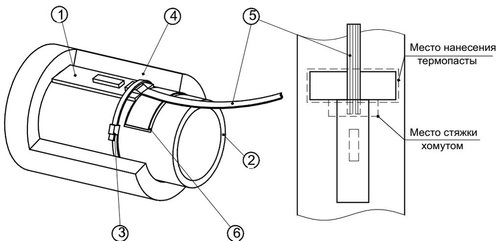
1 — Датчик температуры; 2 — Труба металлическая; 3 — Хомут-стяжка;
