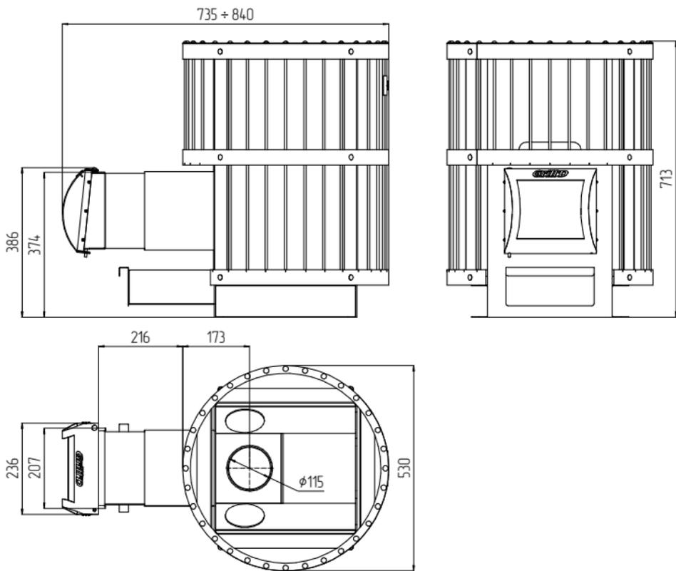
Рис. 2 Размерные характеристики печи «Grill'D» Leo 130 Long
